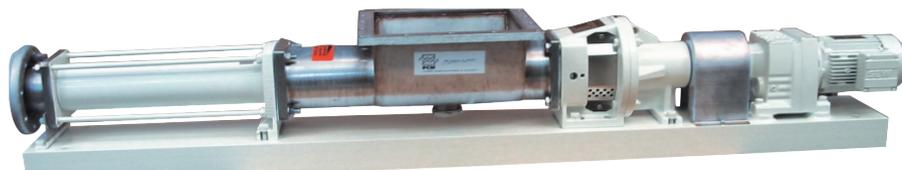
Les pompes IVA sont dotées d'une trémie à l'aspiration et d'une vis de gavage. La trémie permet au fluide de couler librement, tandis que la vis pousse le fluide dans l'ensemble rotor/stator.
