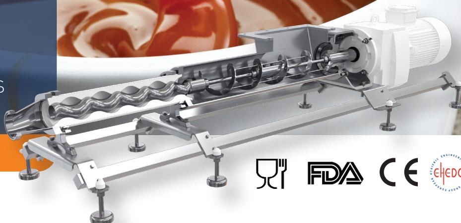
La pompe à cavités progressives PCM HyFeed dotée de la technologie Moineau™ est idéale pour le transfert de fluides très visqueux, hétérogènes avec ou sans particules, pâteux voir collants et sensibles bactériologiquement.
