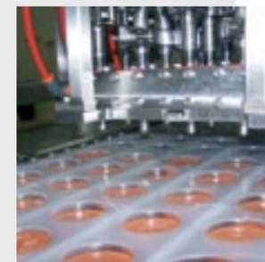
Точность дозирования систем PCM составляет +/- 0,5%
