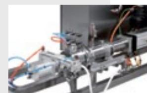
Насос Dosys с приводом Electro-Thrust Cylinder
