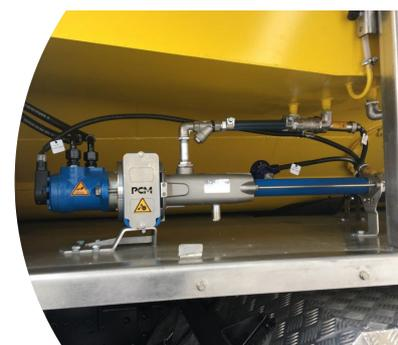
Pompe 1C24S avec moteur hydraulique
