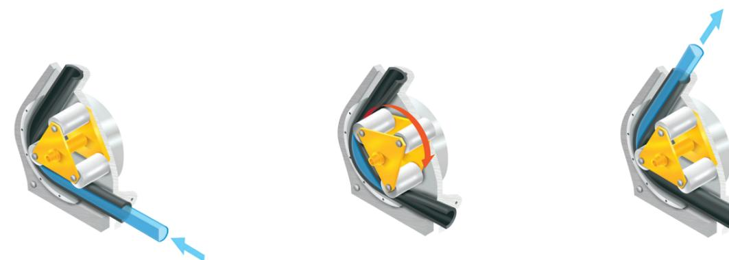
Pour les applications nécessitant de manipuler des composants acides, seul le tuyau est en contact avec le fluide. Aucune partie métallique (cuivre, zinc, nickel) n'est exposée avec le produit pompé. Afin d'augmenter et protéger la pompe au maximum, le corps de celle-ci contient un lubrifiant qui réduit la friction afin d'assurer les performances et de minimiser l'entretien.
