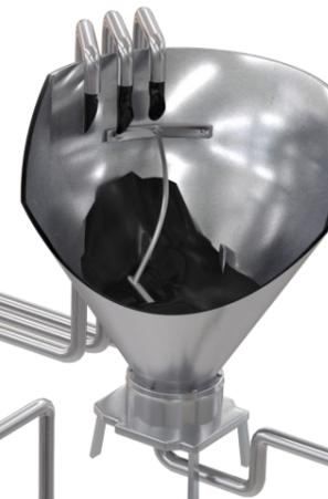
La pâte d'anode ou cathode mélangée est ensuite transférée une nouvelle fois vers un réservoir tampon.
