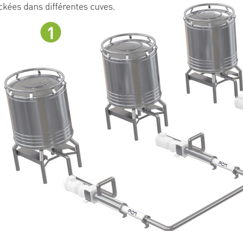
Elles sont ensuite transférées dans un tank pour être mélangées ensemble. La pâte d'anode ou cathode est donc mélangée à un solvant (NMP) pour rendre l'enduction plus facile et un liant (noir de carbone) afin d'améliorer l'efficacité des batteries.
