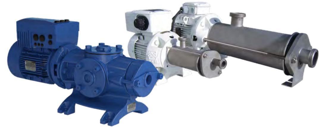
Basato sulla tecnologia PCP Moineau™, la pompa a cavità progressiva EcoMoineau™ PCM con statore flottante è ideale per esigenze di spazio ridotto. Usando uno statore flottante senza telaio, questo PCP piccolo non richiede la biella utilizzata dalle pompe a cavità progressiva convenzionali. **La flessibilità dello statore consente al rotore di ruotare eccentricamente, poiché il rotore è direttamente collegato all'azionamento. Il corpo della pompa è di conseguenza più corto.**
