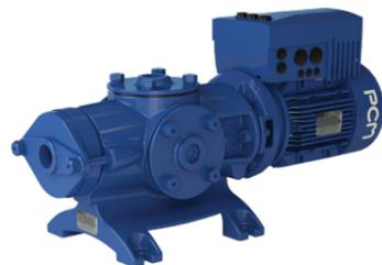
**Pompe PCM MSH** : pompe à trémie avec vis d'Archimède ouverte, parfaite pour le transfert de boues épaissies ou de boues faiblement déshydratées. La pompe peut gérer une viscosité jusqu'à 50000 cps.
