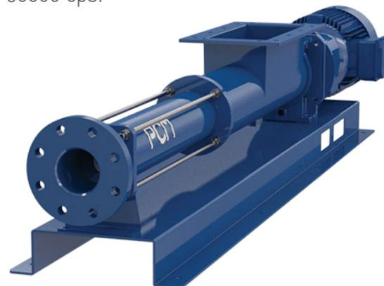
La série **PCM MVA-FF** est la pompe dédiée au transfert de boues déshydratées. Équipée d'une trémie de 1000 mm et d'une vis d'Archimède ouverte, cette pompe est capable de transférer des boues contenant jusqu'à 45 % de matière sèche et atteignant jusqu'à 24 bars de pression.
