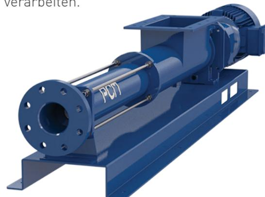
Die **PCM MVAFF-Serie** ist eine Pumpe für den Transport von entwässertem Schlamm. Ausgestattet mit einem 1000 mm Trichter und einer offenen archimedischen Schnecke kann diese Pumpe Schlämme mit einem Trockengehalt von bis zu 45 % und einem Druck von bis zu 24 bar fördern.
