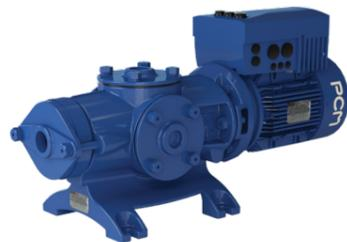
**PCM MSH-Pumpe:** Trichterpumpe mit offener archimedischer Schraube, ideal für die Förderung von eingedicktem Schlamm oder gering entwässertem Schlamm. Die Pumpe kann eine Viskosität von bis zu 50000 cps verarbeiten.
