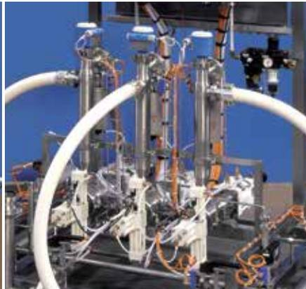
Dosys 柱塞泵和香精检测装置
