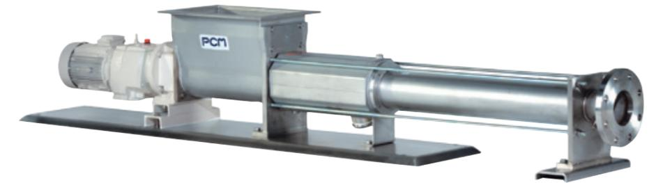
Las bombas IVA/LVA/GVA están equipadas con **una tolva de alimentación y una rosca transportadora**. El diseño de surco abierto permite que el fluido se introduzca sin restricciones mientras la rosca suministra los materiales dentro del estátor del rotor.
