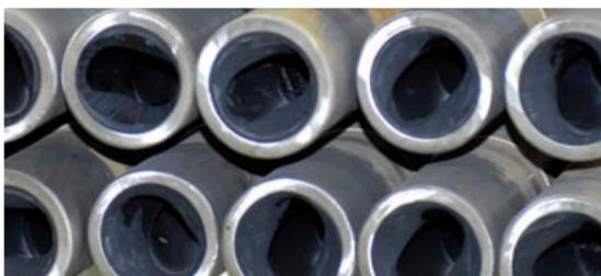
**Contrôle :** Tous les stators sont contrôlés pour garantir leur performance. Le serrage est très important et doit être précis pour avoir le bon débit. Les autres paramètres contrôlés sont les dimensions, le collage, l'épaississement...
