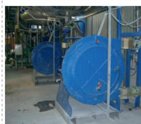
Schlauchpumpe mit gewebeverstärktem Schlauch für hohe Drücke.
