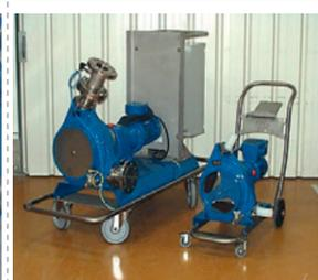
Schlauchpumpe für Niederdruck.
