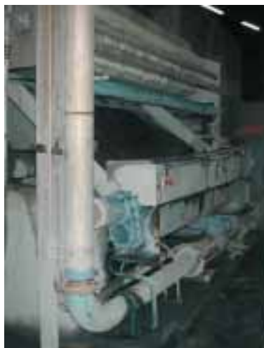
Bomba con cebado (GBB) debajo del filtro prensa
