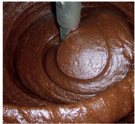
Förderung von extrem zähflüssiger Schokolade zum Einspritzen in Süßspeisen mit dem PCM Viscofeeder™
