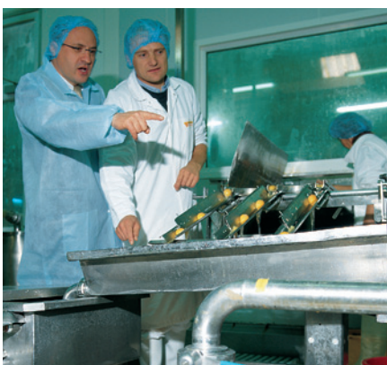
Förderung von Eigelb mit einer PCMPumpe aus der Serie HyCare™ in einer Eiertrennmaschine
