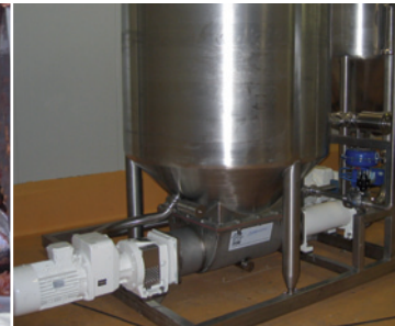
Pumpe angeschlossen unter einem Lagertank
