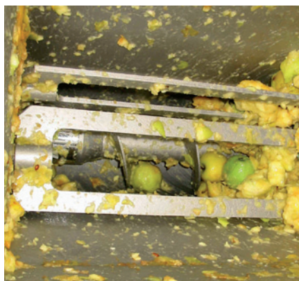
Förderung von ganzen Äpfeln mit einer Pumpe mit Zuführschnecke bei der Zubereitung von Apfelkompott
