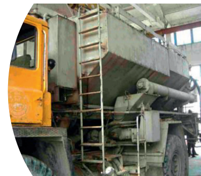
Mezcla explosiva de nitrato de amonio 100,000 cPo - Bomba 60IVA10
