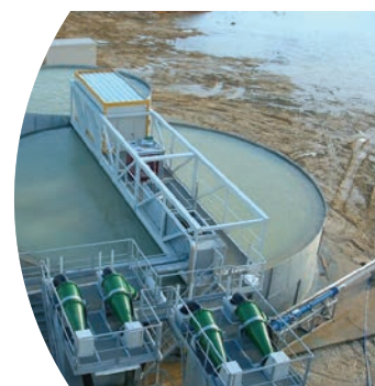
Насос для перекачивания пульпы из сгустителя
